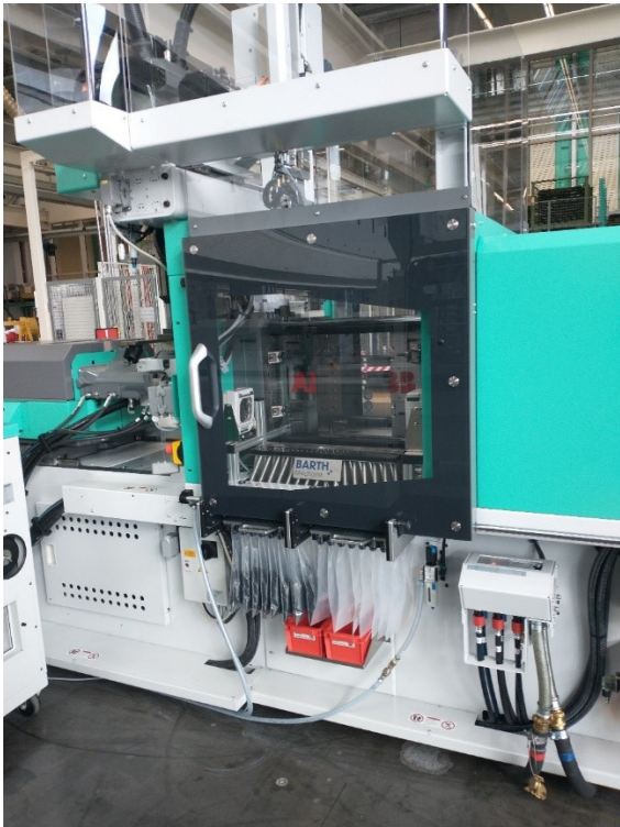
Foto 3: Turn-Key-Anlage mit automatisierter Verpackung
